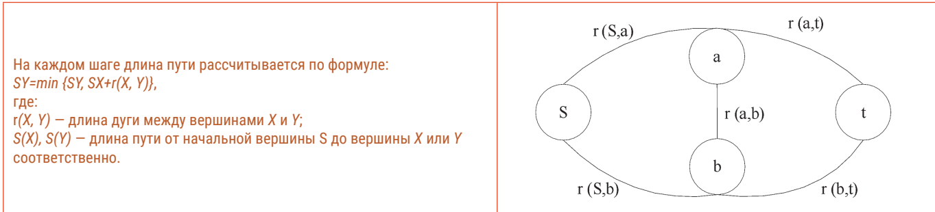
Рис. 2. Иллюстрация к алгоритму Дейкстры. Источник: Богданова Т. К., Жукова Л. В., Нежурина М. И. Fig. 2. The illustration to Dijkstra's algorithm. Source: Bogdanova T. K., Zhukova L. V., Nezhurina M. I.
